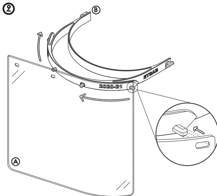
Montar la protección sobre la visera, introduciendo los orificios en los 4 pivotes, iniciando en uno de los extremos. El último pivote entra a presión.
