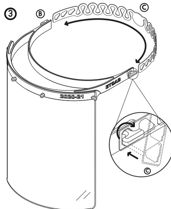
Colocar la banda en la parte posterior. La pieza cuenta con distintas ranuras para ajustar la distancia
